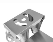
Detalhe proteção fixa do bocal
